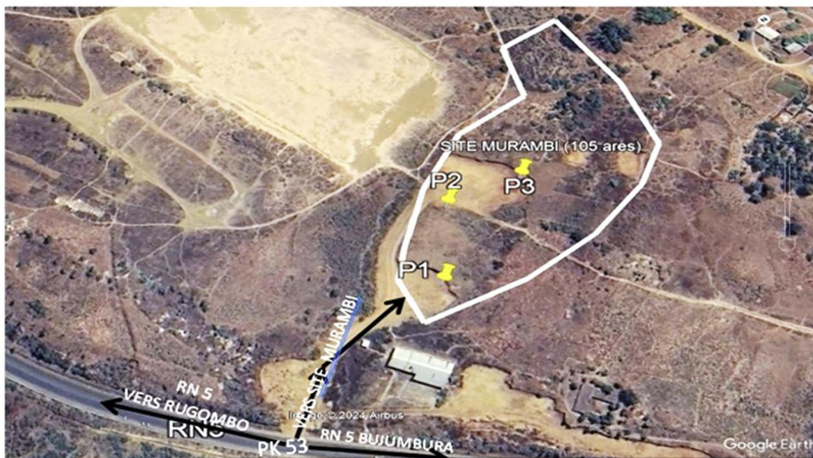
Figure 5 : Le site MURAMBI-Matériaux latéritiques d'assises de la chaussée
